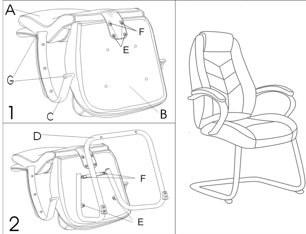
1. Спинку (A) соедините с сиденьем (B) с помощью винтов (E и F) согласно иллюстрации 1. Подлокотники (C) соедините с сиденьем (B) и спинкой (A) с помощью винтов (G).
